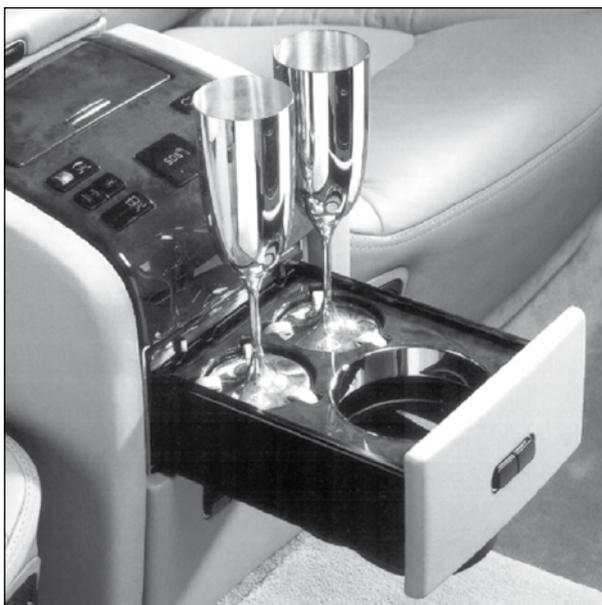
Figur 10: Getränkehalter im Maybach 57/62 in der Fond-Mittelkonsole (Foto mit Genehmigung der Daimler AG).
