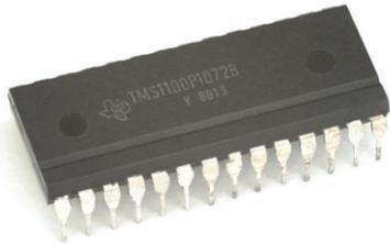
• **1971.** Die ersten Mikroprozessoren werden vorgestellt – zeitgleich entwickelt von den US-amerikanischen Firmen Intel und Texas Instruments (Bild oben).
