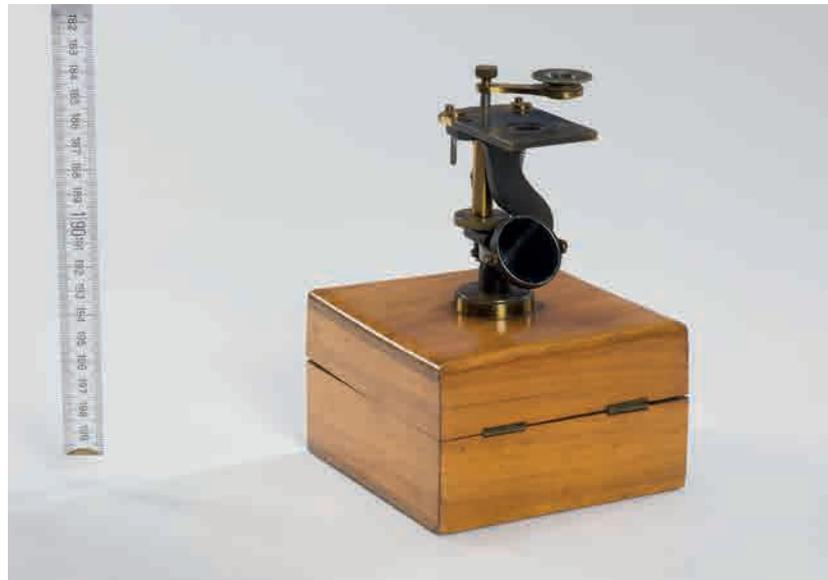
Frühes einfaches Mikroskop, wie es Carl Zeiss ab 1847 herstellte
